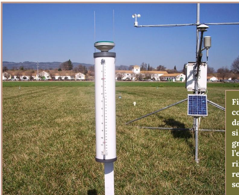
**Figura 5 - La stazione agrometeorologica come strumento essenziale per ricavare i dati necessari al bilancio idrico. Con essa si misurano la precipitazione e le grandezze utili per stimare l'evapotraspirazione da coltura di riferimento (temperatura dell'aria, umidità relativa, velocità del vento e radiazione solare globale).**
